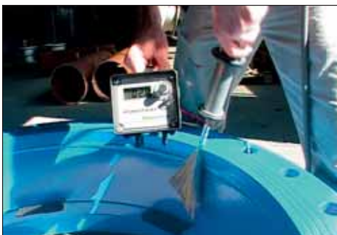
Prüfung auf Porendichte
