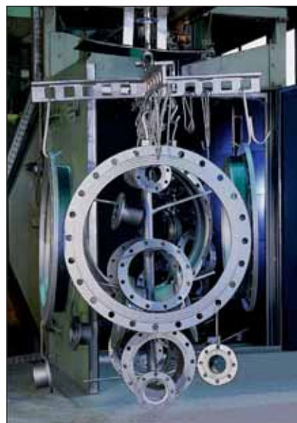
Automatische Schaufelrad Strahlanlage mit Stahlkugeln
