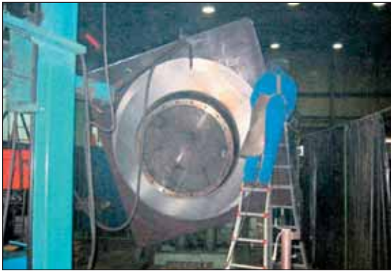
Handschweissung auf Schweißdrehvorrichtung
