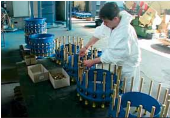
Montieren von Ausbaustücken
